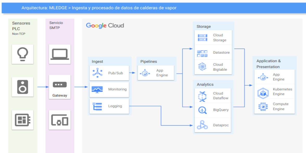
Ilustración 5: Diagrama arquitectura adquisición de datos del Edge al Cloud
