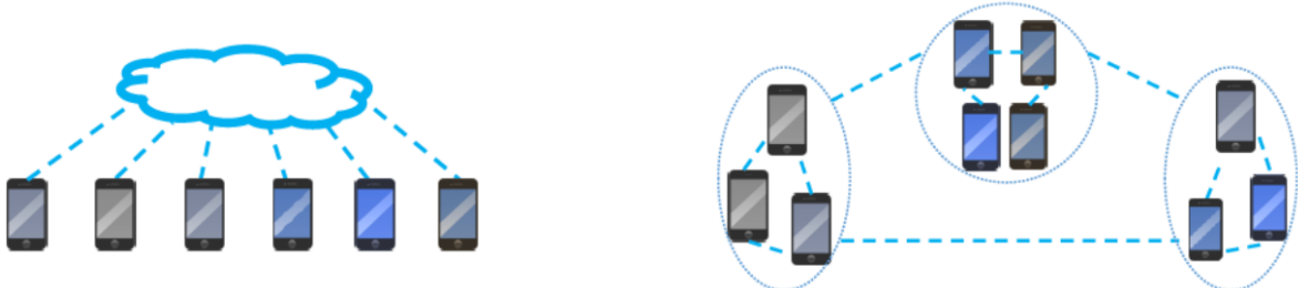
Figura 3. Topologías centralizadas (izq.) y descentralizadas (der.) de aprendizaje federado [Li19]
